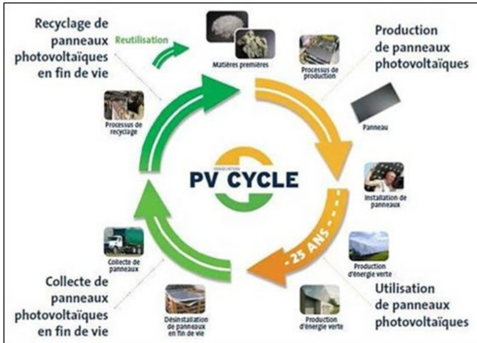
Figure 26 : Vie d'une installation photovoltaïque (Source : PV Cycle)
